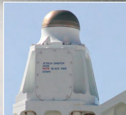
Az űrrepülőgép egyik rögzítési pontja a szállító Boeing-747-en. A felirat: "Ide rögzítsd az orbitert FIGYELEM fekete oldalával lefelé"
