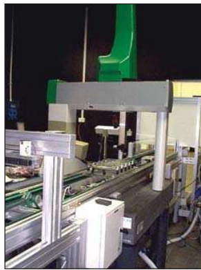
2. kép Egy öt kristályból álló egység vizsgálata jellemzőinek meghatározása céljából. Az eszközöknek a mérési adatokat a munkafolyamatkezelő rendszernek kell továbbítaniuk
