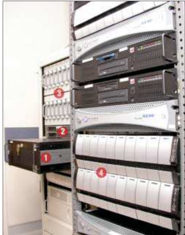
2. kép Első nemzedékbeli kiszolgáló-alkatrészek: 1. VA Linux VAR900 2xXeon-500 1 TB felkínált tárhellyel, 2. Raidion.u2w RAID-vezérlők, 3. 2x8x36 GB SCSI lemez és 4. VA Linux 2230-asok és 3x10x72 GB SCSI lemez
