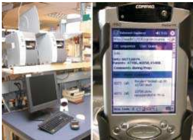
4. kép A vonalkódokat hálózatra kötött Zebra nyomtatók készítik (bal oldalt). A LIMS hordozható felületét iPAQ-ek biztosítják (jobb oldalt)
