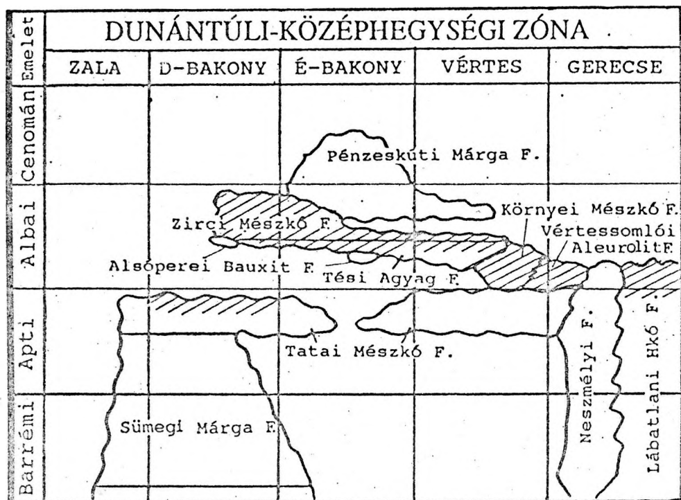
2. ábra. Az Orbitolina -féléket tartalmazó kréta formációk a Dunántúli-középhegységi zónában. (Vonalkázott rész.) Fig. 2. Cretaceous orbitolinid-bearing formations in Transdanubian Central Range zone (hatched area).
