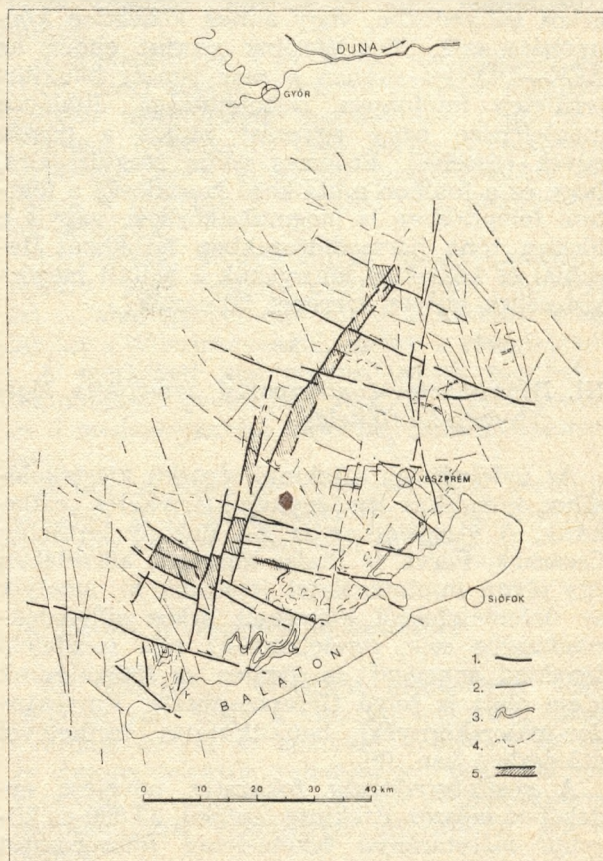
1. ábra: A Dunántúli-középhegység lineamentumainak kiértékelése Landsat űrfelvételekből
