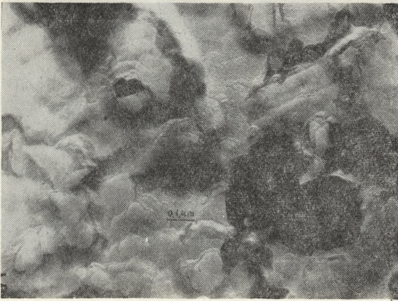
9. kép. Felix II bauxit, kezeletlen. Szén-platina replika. Nagyítás 75 000×
