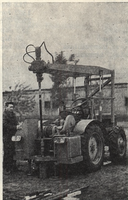
16. ábra: G—50 típusú portabilis fúróberendezés
