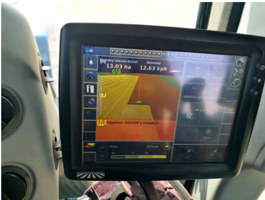
10. ábra: Az erőgép fülkájében elhelyezett a robotkormányást és a precíziós tevékenységet vezérlő monitor (A szerző által készített fotó)
