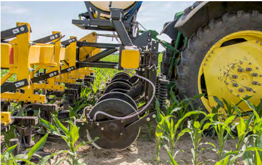
15. ábra: Az erőgép hátsó kerekei mögött lévő tárcsák segítségével kerül a folyékony műtrágya a talajba (A szerző által készített fotó)
