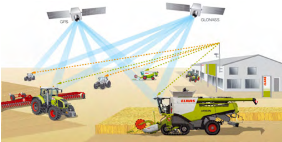
6. ábra: A műholdak méteres pontosságú helymeghatározását az RTK jelek akár 2,5 cm-re pontosítják (Forrás: https://www.axial.hu/cikkek/hirek/claas-smart-farming-konceptio-a-gyakorlatban )
