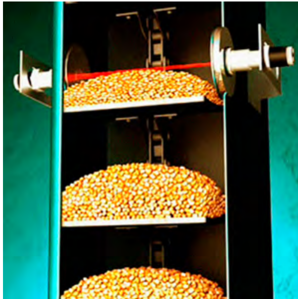
9. ábra: A kombájn magfelhordójában elhelyezett infravörös szenzor (Forrás: https://www.trimble.com/agriculture/yield-monitoring.aspx?tab=product_overview )
