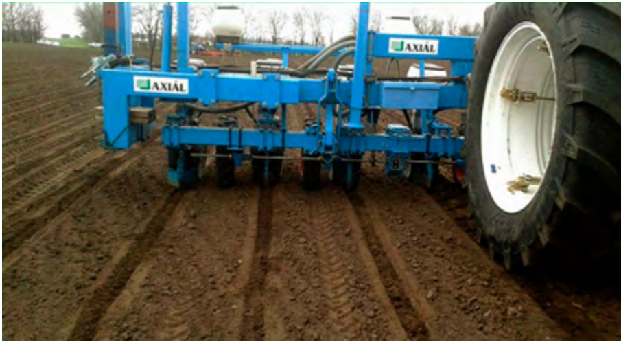
12. ábra: Automatikus szakaszolásra alkalmas függesztett, 12 soros vetőgép (A szerző által készített foto)
