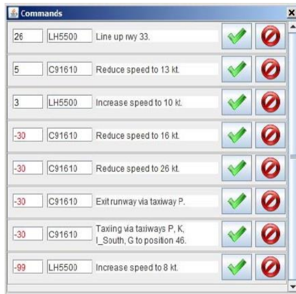
11. ábra Utasítás-javaslatok a gurítóirányítónak egy gurulási útvonaloptimalizáló szoftverben [46]
