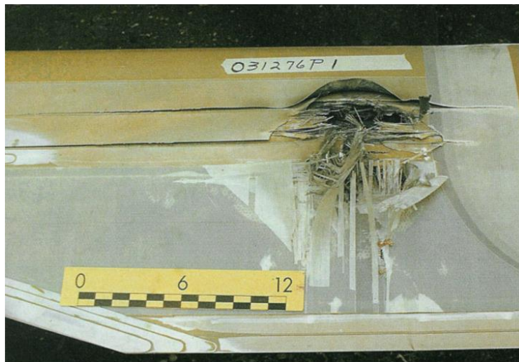
3. ábra Az AH-64 két titánfőtartós forgószárnylapátja, a gépágyú lövedék találatát követően öt órán keresztül megőrizte működőképességét [22]
