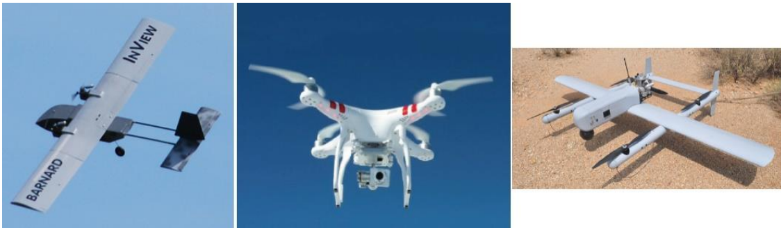
5. ábra Merevszárnya (balra); multi-rotor (középen) és hibrid (jobbra) cargo UAV repülőgépek [6]
