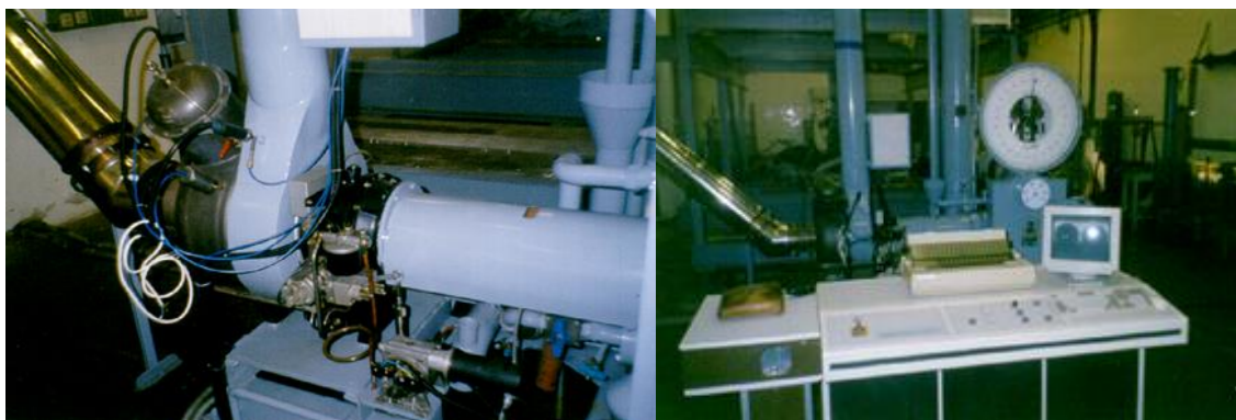
1. ábra A Deutz T216 gázturbina közelről (balra) és a próbapad eredeti kialakítása (jobbra)
