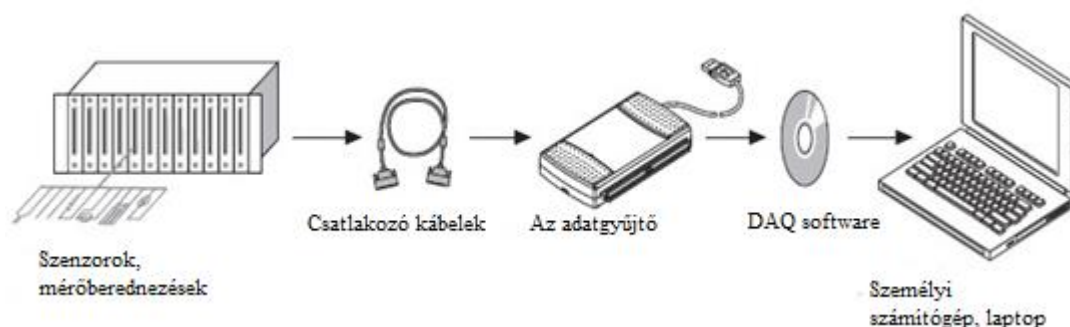
2. ábra Az adatgyűjtő rendszer vázlatos felépítése ([14] nyomán)
