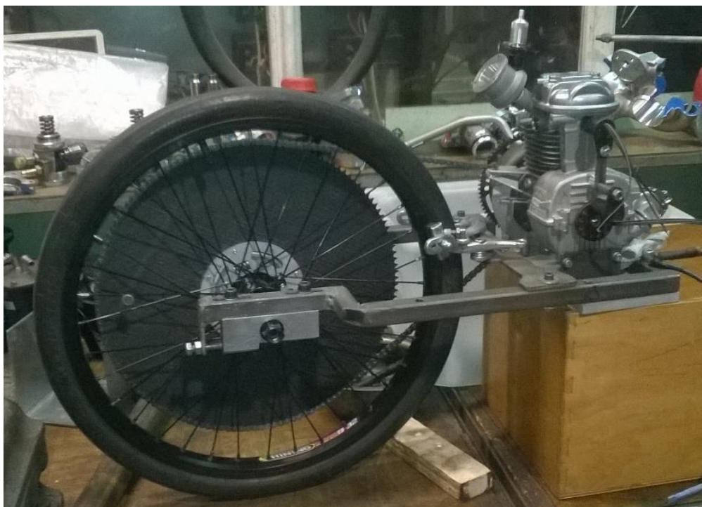
1. ábra Jelenlegi hátsó futómű, hajtás kiszerelt állapotban (saját felvétel)
