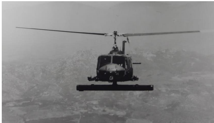
5. kép A SOTAS helikopterre épített célfelderítő rendszer [7]
