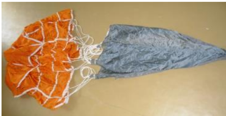
10. ábra A katapultülést a benne ülő kozmonautával együtt stabilizáló, majd a főejtőernyő kihúzódását segítő ejtőernyő „unokája” [37]
