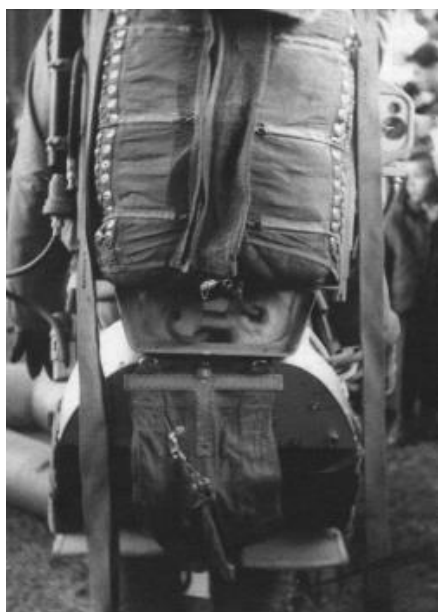
13. ábra A kozmonauta-bábú hátán a le-rántó-gumikkal felszerelt, fém hátlapú ejtő-ernyőtök (amely a katapultülés része is egy- ben), alatta a NAZ-készlet fémkeretes tokja (már nyitott állapotban), előtte a földön az MLASz-1 típusú mentőcsónak látható [42]
