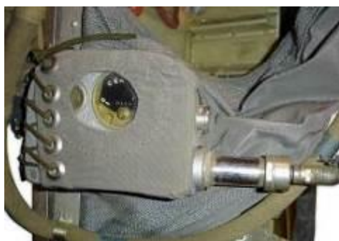
17. ábra KAP-3 típusú nyitóműszer a NAZ-készlet tokkeretéhez... [47]
