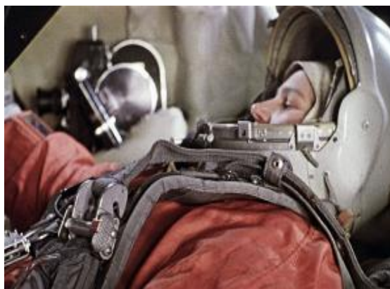
23. ábra Speciális, OSzK típustól eltérő leoldózár Valentyina V. Tyereskova ejtőernyő hevederén. Figyelmet érdemel a kézikioldó-fogantyú [53]
