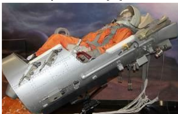
7. ábra A katapultülés valós nézete egy múzeumi kiállításról. Jól megfigyelhető a „Szokol 33 ” SzK-1 típusú szkafander és a hermetikus sisak együttese az ülésben, valamint annak oldalára rögzítve az ejtőernyő nyitóműszerek csoportja [34]
