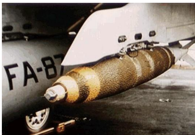
6. kép: MK-82-es bomba megnövelt hőálló burkolattal [12]
