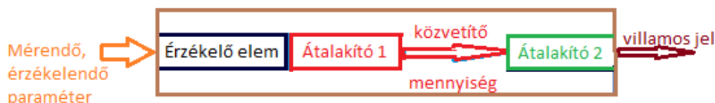
1. ábra Egyszerű érzékelő, „közvetett mérés” 9
