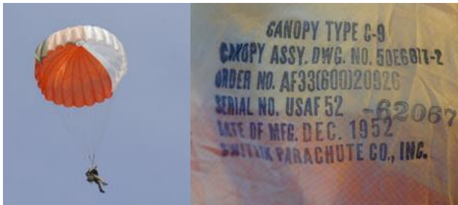
5. és 6. ábra A C-9 típusú pilóta mentőernyő és a kupolán elhelyezett gyártó cég jelzése [16]. A felirat alapján jól látható, hogy az adott ejtőernyőt az Amerikai Egyesült Államok Légieréje részére készítették, 1952. decemberében
