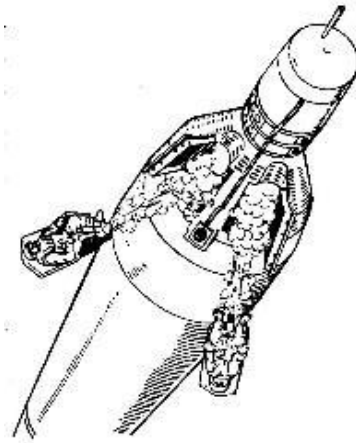
1. ábra. A Gemini űrhajó katapultrendszerének működési vázlata [13]
