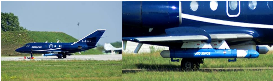
4. ábra COBHAM Aviation repülőgépe és a szárny alá függesztett zavarókonténer (POD) [16]
