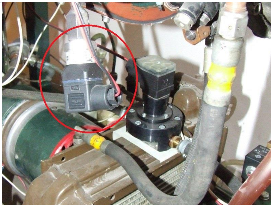
12. ábra A tüzelőanyag nyomástávadó a fűvókakoszorú előtt
