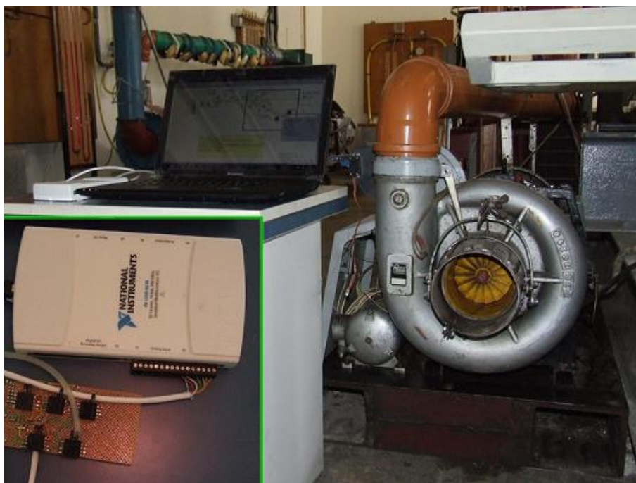
13. ábra: Az NI USB-6218 a tanszéki kompresszoros próbapadhoz illesztve
