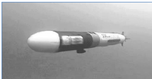
13. ábra Az ICxTechnologies' által kifejlesztett, SeaDog elnevezésű, robbanóanyag felderítővel felszerelt víz alatti jármű. (Az ICx Technologies engedélyével.)
