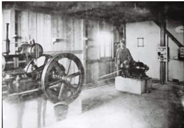
27. ábra Áramfejlesztő a léghajóbázison
