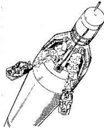
1. ábra. A Gemini űrhajó katapultrendszerének működési vázlata [13]
