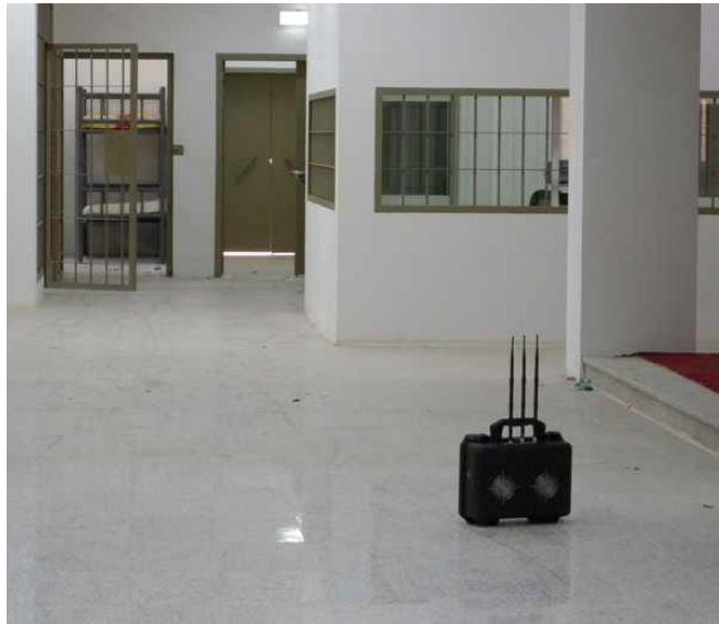
1. ábra Hordozható elektronikai zavaróeszköz egy börtönön belül elhelyezve [8]
