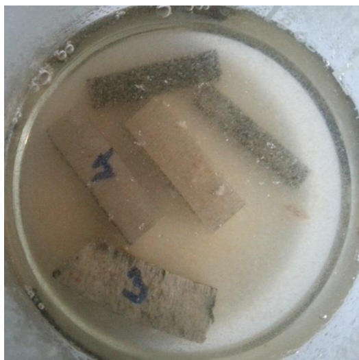
5. ábra Korróziós kísérlet mesterséges tengervízben 14
