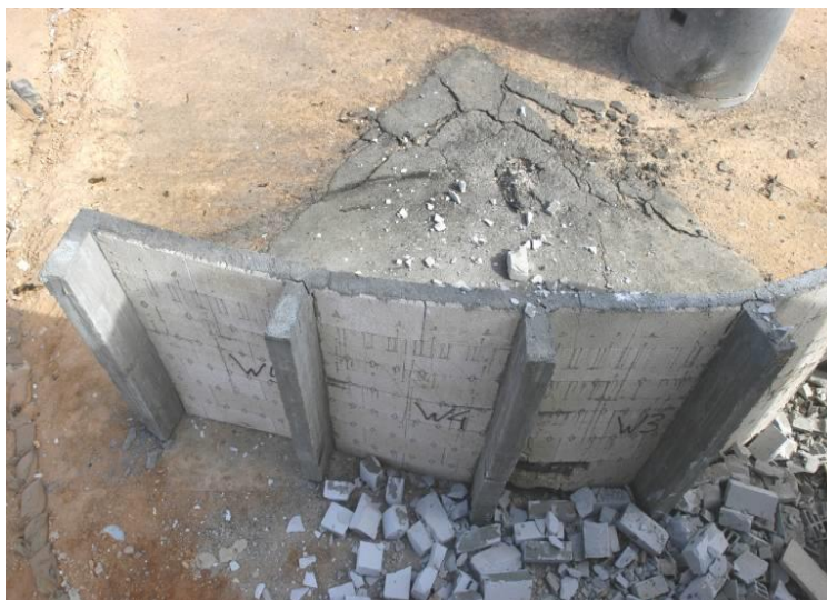
5. ábra Merevítővel megerősített falszerkezet [5]
