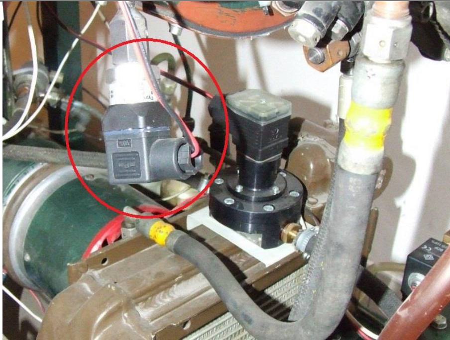
12. ábra A tüzelőanyag nyomástávadó a fűvókakoszorú előtt
