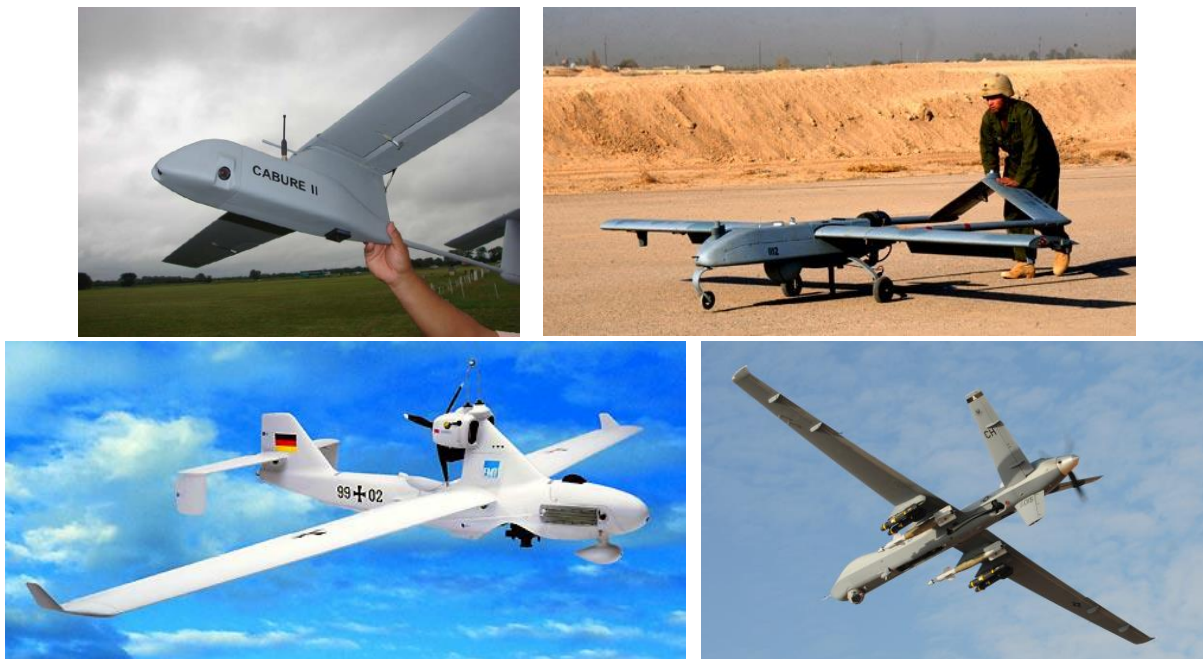
3. ábra a kis-, a rövid-, a közepes és a megnövelt hatótávolságú közepes kategóriájú UAV-k
