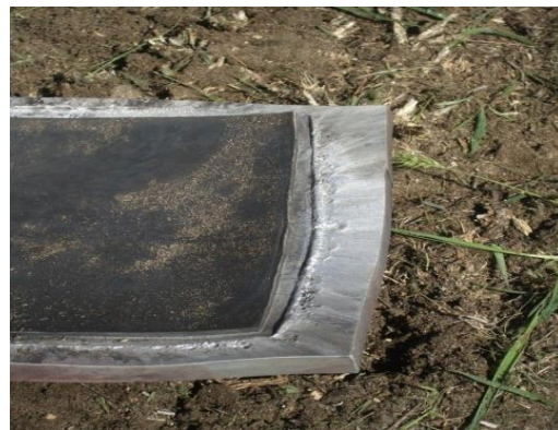
4. ábra A kész plattírozott lemez
