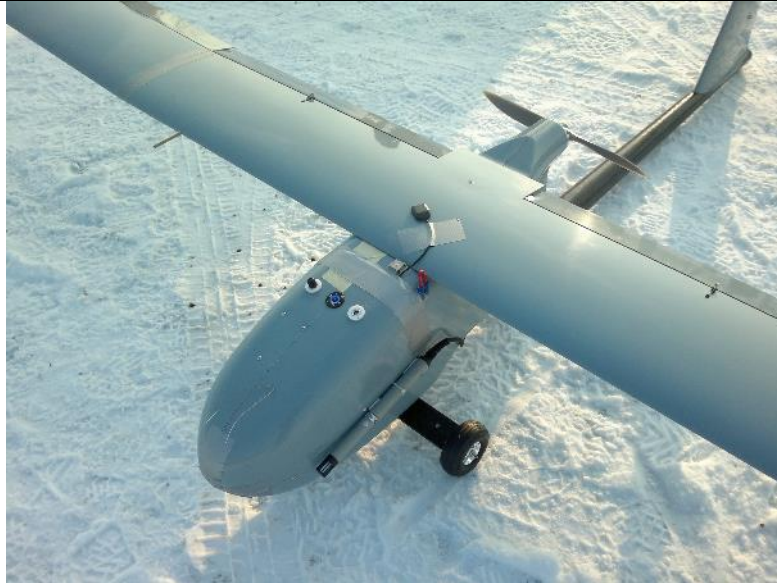
1. ábra Az UAV orr része a műszerekkel (bal oldalon a Vaisala HMP45 hőmérséklet és légnedvesség szenzor, a szárnyon a GPS vevőegység
