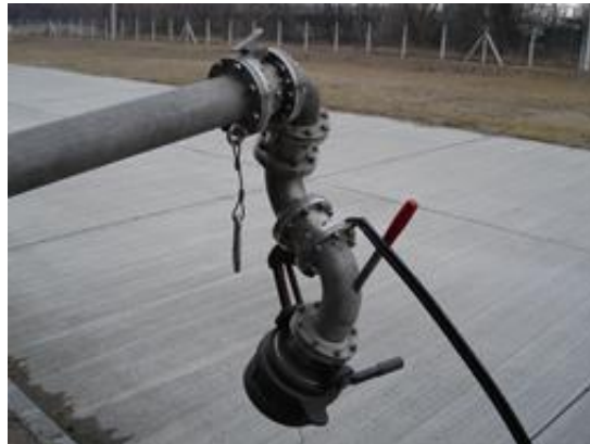
9. ábra Csepegésgátló töltő berendezés [fotó: Szabó Zsolt]
