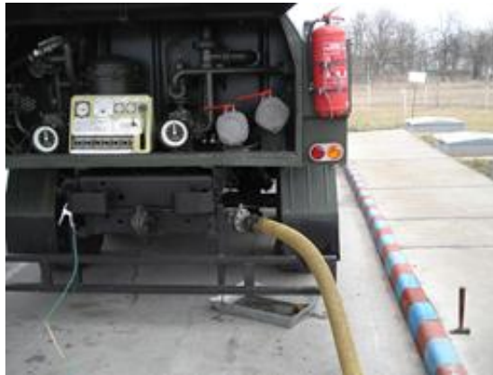
11. ábra Csöpögést felfogó edény [fotó: Szabó Zsolt]
