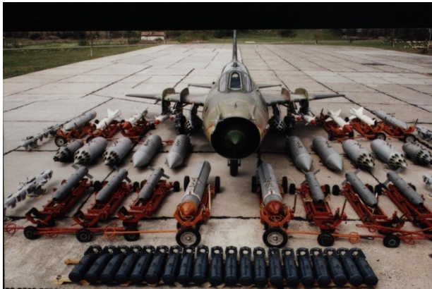
A Szu-22M3-as repülőgéptípus lehetséges függesztményei egy részével, 63°-os szárnynyílással
