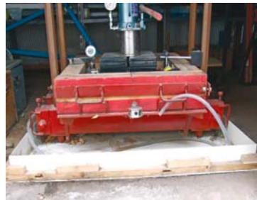
(d) The lateral stress measuring gauge,
