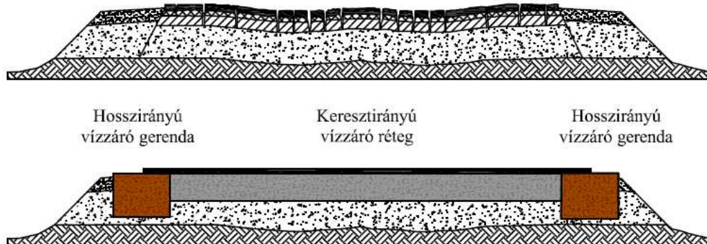
17. ábra: Leromlott állapotú pályaszerkezet felújítása NovoFlex technológiával
