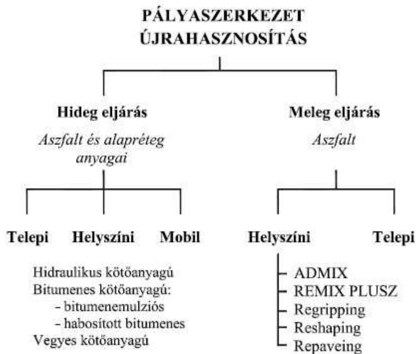
2. ábra: Pályaszerkezet újrahasznosítási technológiák
