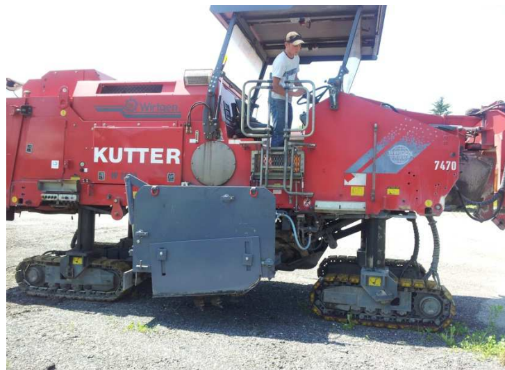
8. kép: A NovoFlex technológia építésére alkalmas célgép
