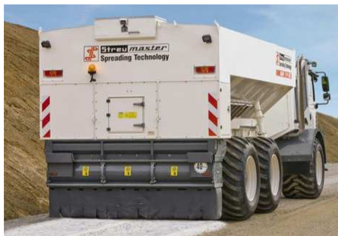
2. kép: SW 19 SC típusú száraz kötőanyag terítő gép
