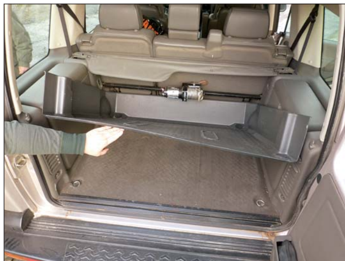
A Land Rover Discovery kivehető, gyári csomagtartó betétje megvédi a kárpitot a szennyeződéstől
