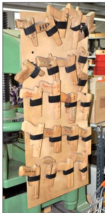
Méret pontos pisztolyok fából, pisztolytáskák gyártásához
