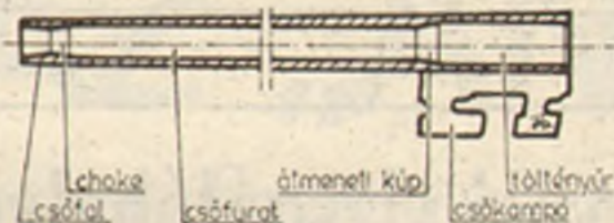
2. sz. ábra. Sörétes cső hosszmetézeté
