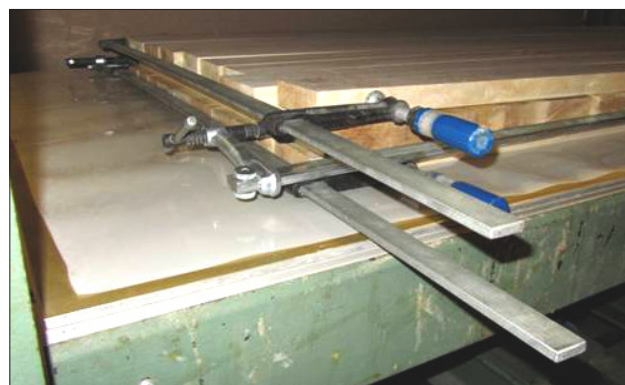
2. ábra A kész teríték présbe helyezése, az oldalirányú szorítás fenntartásával
