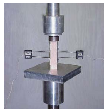
5. ábra – A nyomószilárdság és rugalmassági modulusz meghatározásához használt mérési összeállítás
