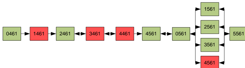
13. ábra: A vizsgált gyártórendszer felépítettsége a karbantartásra beütemezhető berendezésekkel kiemelve
