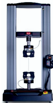
1. ábra. Instron 5965 szakítógép 18
