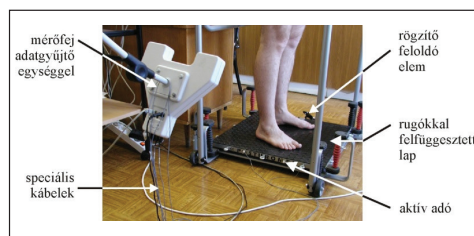
1. ábra. Mérési elrendezés. PosturoMed® lap mozgásának rögzítéséhez az ultrahangalapú mérőfej 30°-os dőlésszögben a vizsgált személy oldalánál, míg két egyedi érzékelő a lap oldalán található
