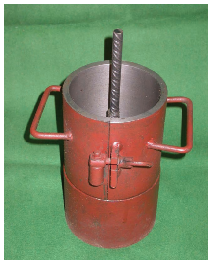
2. ábra Az alkalmazott acélsablon összeszerelt állapotban Fig. 2. Steel mould ready for concreting
