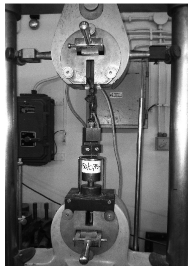
3. ábra Szálkihúzó berendezés Fig. 3. Pull-out device
