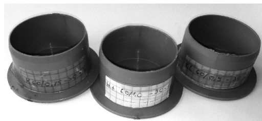
2. ábra Próbatetek zsaluzata Fig. 2. Specimens formwork
