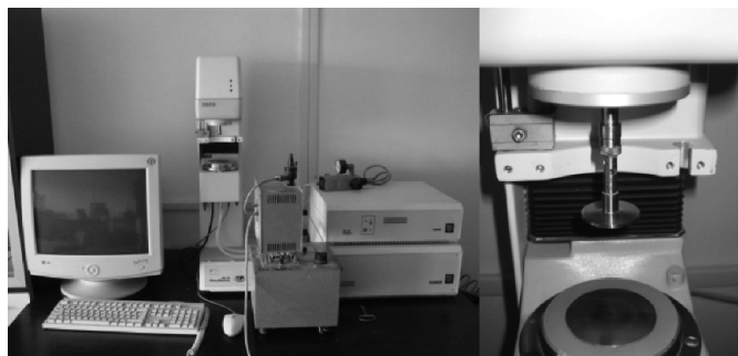
3. ábra Az RS80 reométer és a CP 2Ti 25mm mérőfej Fig. 3. RS80 Rheometer with CP2Ti 25mm
