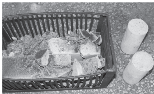
6. ábra A próbatestek az 1000 °C-os hőterhelés után Fig. 6. Specimens after 1000 °C temperature loading
