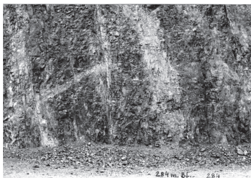
8. ábra Törések, kőzetrések mentén áramló oldatok hatására átalakult, elbomlott andezit az új bánya 285 mBf. szint, Ny-i bányafalán
