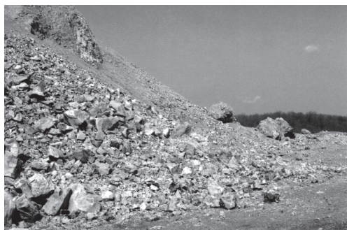
9. ábra Törési zónában mutatkozó erős kőpergés és omlás az új bánya 345 mBf. szint, Ny-i bányafalán
