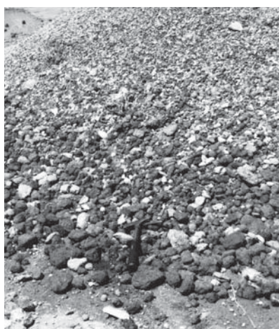
10. ábra Mosás, osztályozás során leválasztódott, minőségileg alkalmatlan, barna, limonitos homokkő gumók Fig. 10. Separated through washing and classification, ill-quality, brown, limonite-containing sandstone nubs
