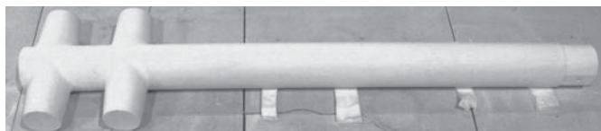
2b. ábra 2m hosszú keverő, keverési átmérő 400 mm Fig. 2b. 2 m long, 400 mm diameter mixer
