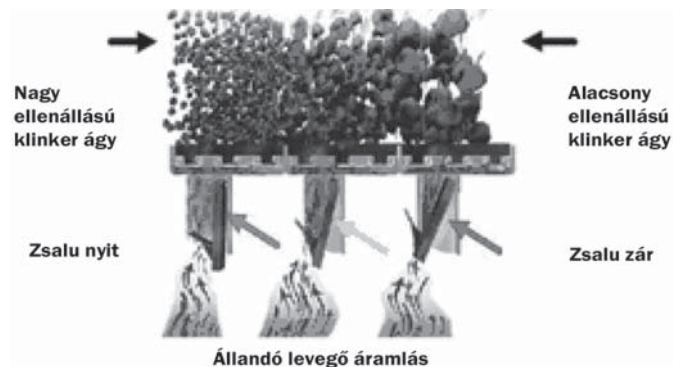
4. ábra Levegő aláfúvás szabályozása a klinkerágy ellenállás függvényében (KHD) Fig. 4. Regulation of the air flow depending on the clinker bed resistance (KHD)
