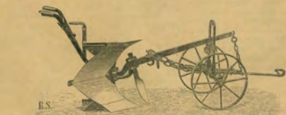
86. Ábra. Sack kisebb váltva forgató hegyi ekéje vízszintes tengelyű eketárgyával.
