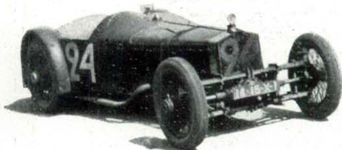
A francia elsőkerék-meghajtásos Tracta-versenykocsi.
