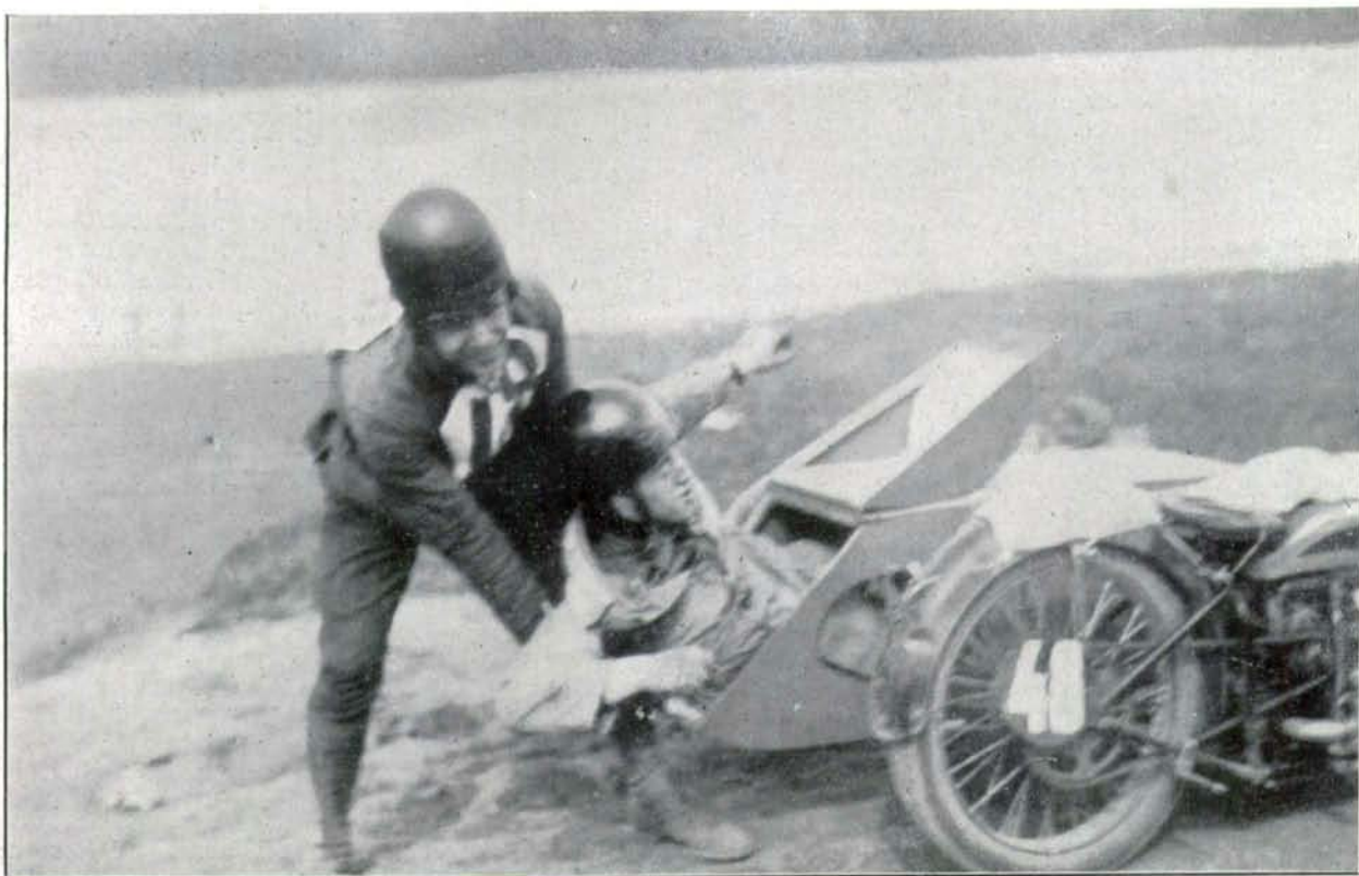
Rostás István utasa „kiszáll” az oldalkocsiból. Rostás, aki 500 km.-es ohv. Douglas-gépével a nap legjobb oldalkocsi-idejét futotta, sokat köszönhet a sajátmaga által az áramvonal-elv figyelembevételével konstruált könnyű sidecarnak.
