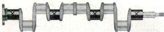
Egy négy helyen csapágyazott motorfőtengely. A keresztrel jelzett helyek jelképezik a csapágyakat.
