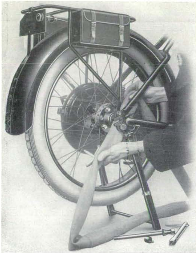
Hátulso keréknél tömlőcsere esetén a középtengely kihuzása után teljesen kiemelhető a tömlő. (A. J. S. patent.)
