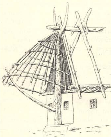
49. kép. A matyó ház bugyának és fedelének belső szerkezete.
