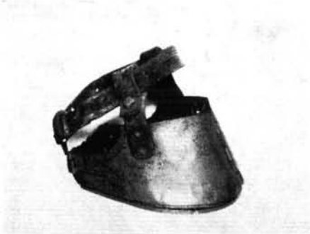
8. kép: Gyógypatkó lemezből, beteg patára. Ferkó János kovácsmester készítette Sajóvámoson 1930-ban
