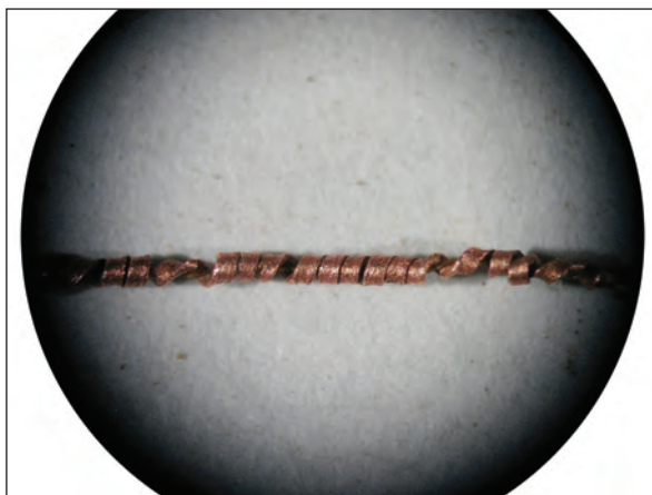
1. kép. Sztereómikroszkópos felvétel, a fémszalag méretei 0,1 mm vastag és 0.24 mm széles
