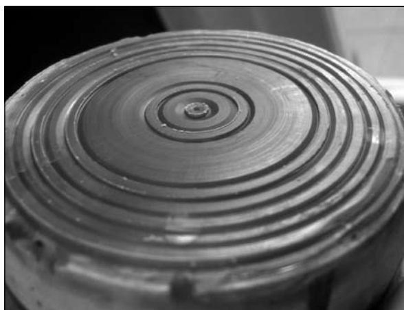
4. kép. A tükör viaszmodelljének forgácsolása során tökéletesen sík felület alakítható ki.
