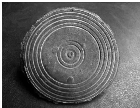
5. kép. A magra ecseteléssel felvitt viaszból esztergált tükörmodell magas-öntartalmú bronzötvözetének nyers öntvénye.
